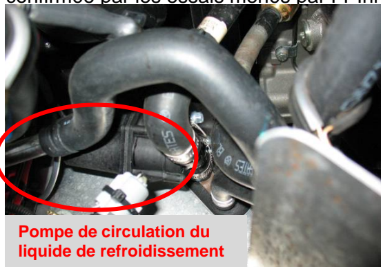
Pompe de circulation du liquide de refroidissement
