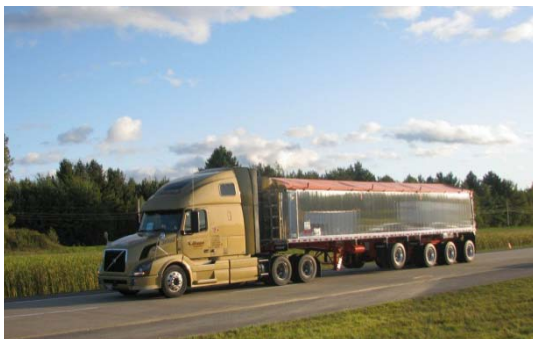
Système de bâche sur une semi-remorque à benne
