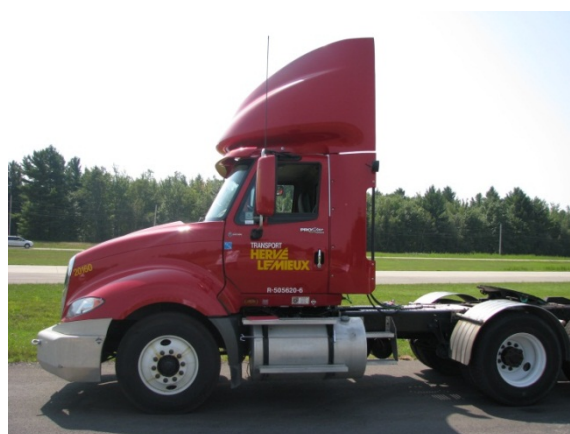
Carénages de cabine perfectionnés pour tracteurs à cabine de jour (sans couchette)
