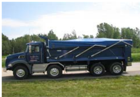
Système de bâche sur un camion à benne
