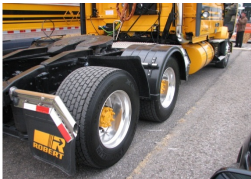
Véhicule équipé de pneus larges
