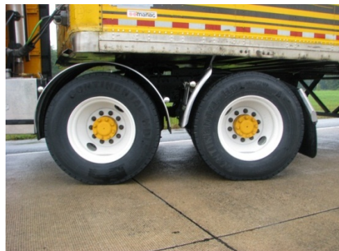
Véhicule équipé de pneus à faible résistance au roulement
