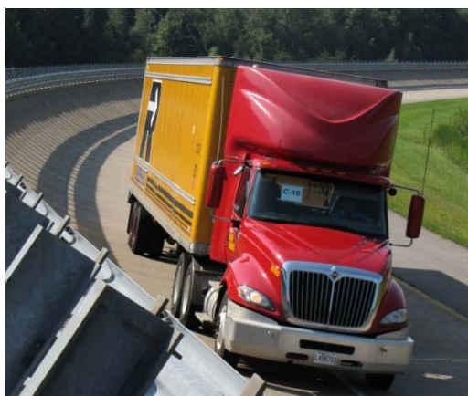
Carénages de cabine perfectionnés pour tracteurs à cabine de jour (sans couchette)
