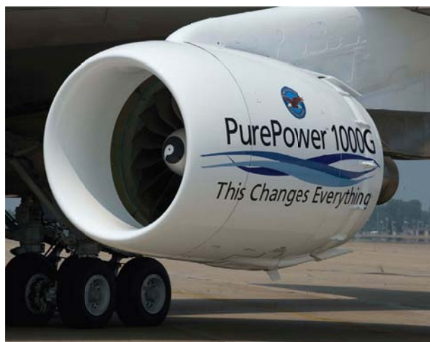
Turbosoufflante à réducteur installée sur un avion Bombardier
