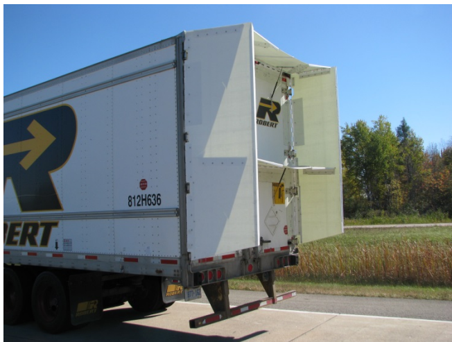
Véhicule équipé de déflecteur arrière pour remorque
